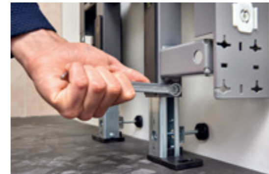
↑ Selon la configuration d'installation, la hauteur est ajustable jusqu'à + 7 cm. Cela ne nécessite aucun outillage spécial.
