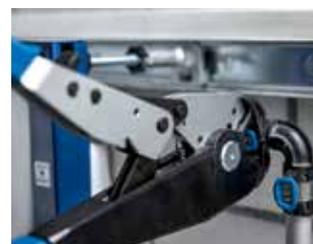
La sertisseuse manuelle couvre cinq dimensions et n'a besoin ni d'électricité ni d'accumulateurs.
